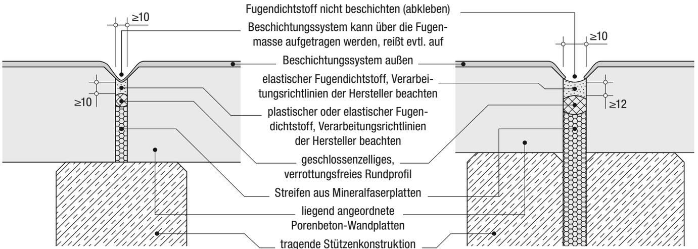
Bild 2: Fugenausbildungen mit Dichtstoffen
