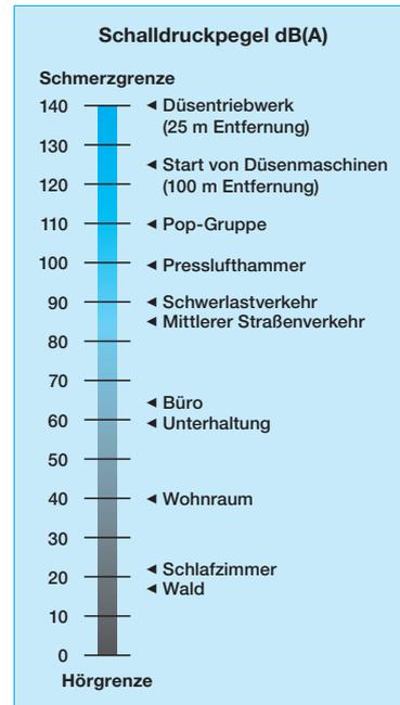
Abb. 1.1: Darstellung der Schallschutzniveaus am Beispiel verschiedener Geräuscharten
