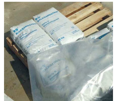
Bild 9: Der Werk-Trockenmörtel ist vor Witterungseinflüssen zu schützen.
