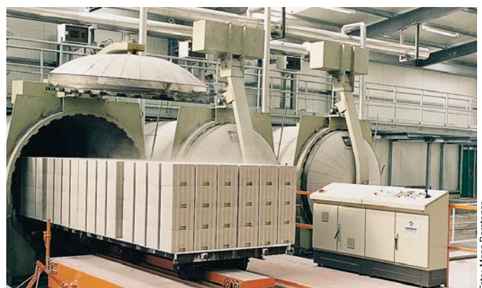
Bild 6: Das Härten der Rohlinge erfolgt in Dampfhärtekesseln.
