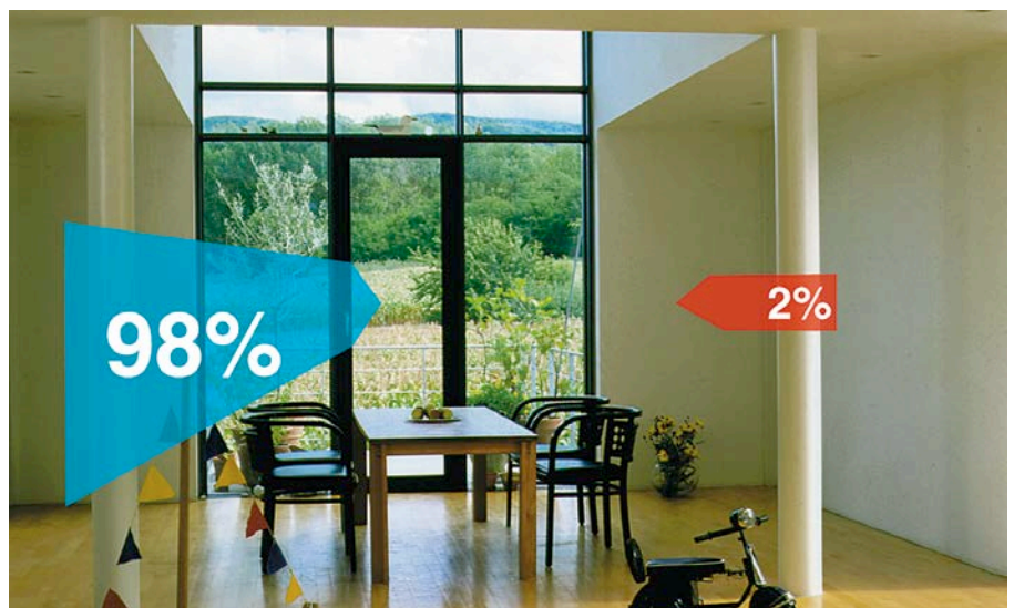
Bild 20: Feuchtetransport aus Räumen findet zu 98 % über Lüftung und nur zu 2 % durch Diffusion statt.
