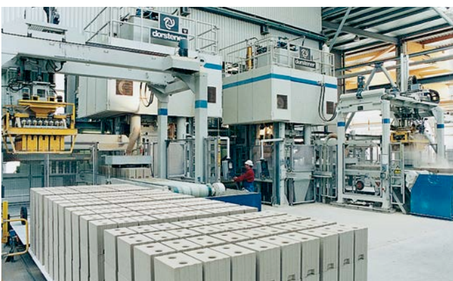
Bild 5: Nach dem Mischen werden die Rohlinge gepresst.
