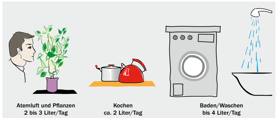
Bild 19: Entstehung von Wasserdampf in einem 4-Personen-Haushalt
