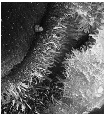
Bild 1: Raster-Elektronen-Mikroskopaufnahme (REM) von Kalksandstein
