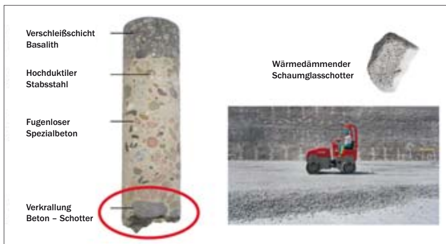
Bild 6: Fugenlose und gedämmte Bodenplatte
