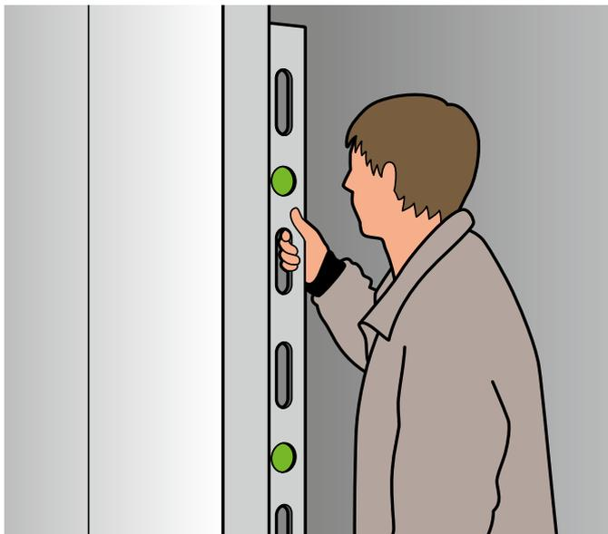
Während mit der Wasserwaage oder dem Richtscheit das Lot kontrolliert wird, können bereits die nächsten Elemente transportiert und aufgerichtet werden. Vor der Montage jedes weiteren Elements ist jedoch auf der senkrechten Anschlussfuge des bereits stehenden Elements ca. 3 mm Dünnbettmörtel mit einer geeigneten Zahnkelle aufzutragen.
