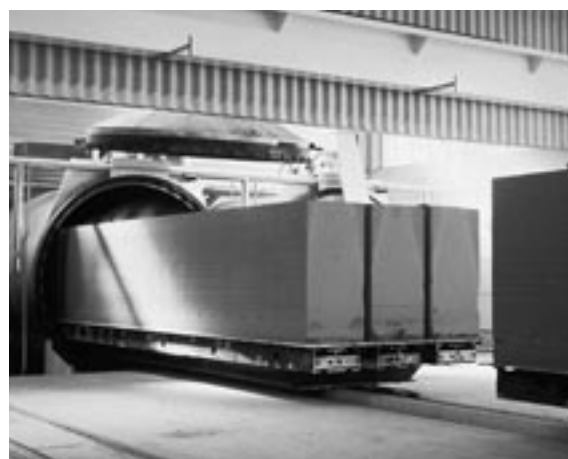
Abb. 1.11: Dampfdruckhärtung im Autoklaven
