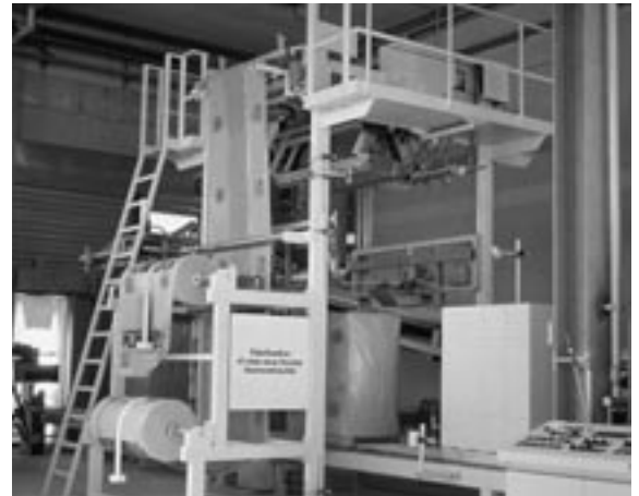
Abb. 1.16: Verpackung von Mauersteinen aus Porenbeton mit Polyethylenfolie
