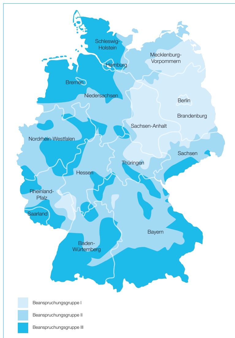
Abb. 6.5: Schlagregenbeanspruchung in der Bundesrepublik Deutschland gemäß DIN 4108-3 [71.2]
