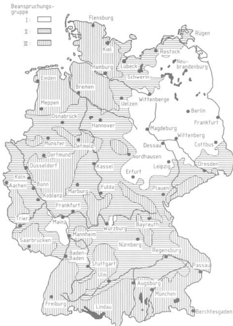
Bild 21: Schlagregenbeanspruchung nach DIN 4108-3.
