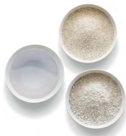
Kalk, Sand und Wasser: Die drei natürlichen und regional gewonnenen Rohstoffe bilden die Zutatenliste des Kalksandsteins.
