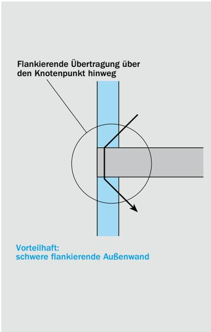
Bild 24: Flankierende Übertragung (vertikal) über die Außenwand
