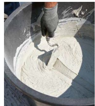
Einfacher Test: Bleibt die Furche des Kellenzugs für einen Moment stehen, besitzt der Mörtel die richtige Konsistenz.
