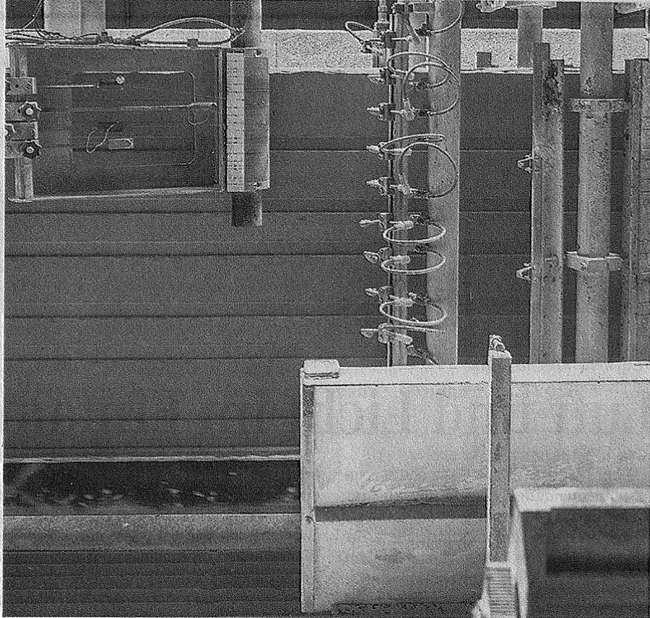
Bei diesem Produktionsschritt werden aus dem Porenbetonkuchen die späteren Steinformate geschnitten. Hierbei anfallender Abfall wird umgehend der Produktion wieder zugeführt.
