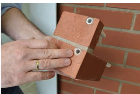
Einfacher Wärmetauscher: In die genuteten Klinker wurden Mehrschichtverbundrohre eingesetzt. Darin zirkuliert ein heruntergekühltes Fluid.
