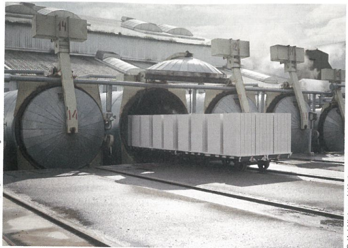
Die Steine müssen nicht gebrannt, sondern bei wesentlich niedrigeren Temperaturen lediglich unter Wasserdampf ausgehärtet werden.
